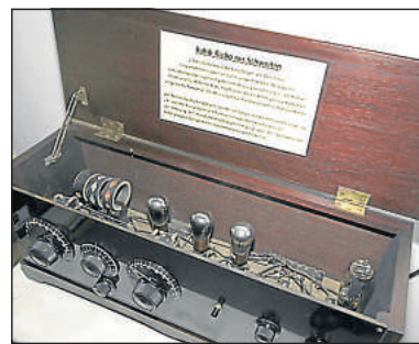
Gar nicht so einfach: Dieses Balkt-Radio aus Schweden verfügt über austauschbare Steckspulen.
